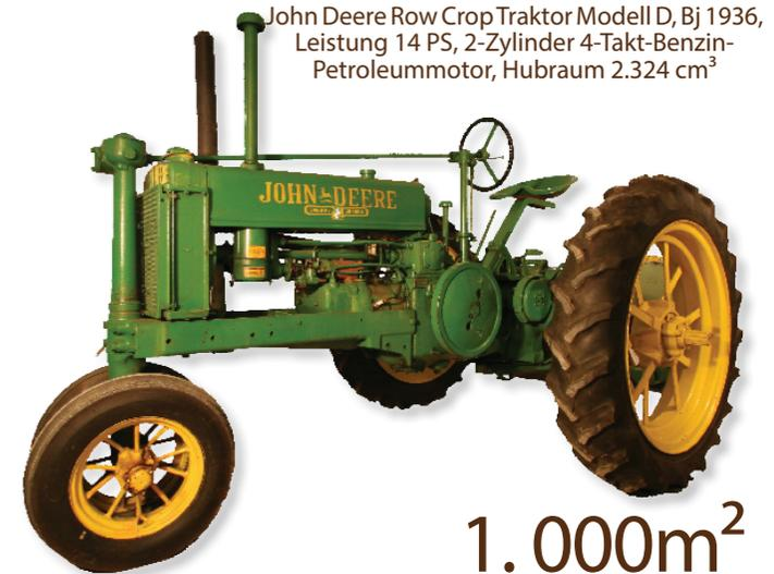
John Deere Row Crop Traktor Modell D, Bj 1936, Leistung 14 PS, 2-Zylinder 4-Takt-Benzin-Petroleummotor, Hubraum 2.324 cm<sup>3</sup>
